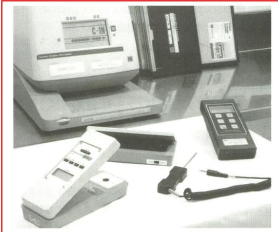
**Fig. 1.70** Sensitômetro, densitômetro e termômetro digital
