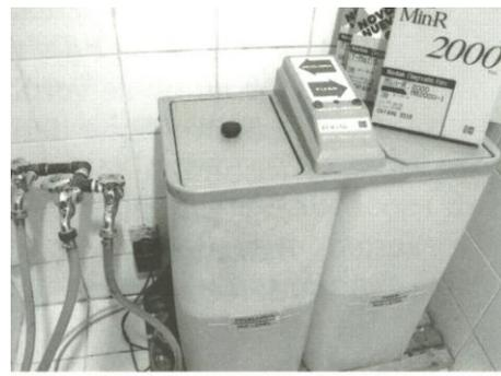
**Fig. 1.68** Tanque reservatório e de preparação de revelador e fixador (automixer). Este sistema possui mecanismo para preparação dos químicos para que a diluição seja sempre a ideal e possui também mecanismo de agitação dos químicos, evitando que cristais se depositem no fundo dos tanques. A esquerda, filtro de água, para evitar que sujeiras trazidas dos encanamentos possam entrar na processadora e causar artefatos nos filmes.
