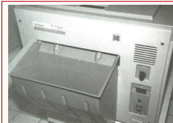
**Fig.1.67** Processadora Kodak M35 dedicada à mamografia, com tempo de processamento de 2h30 min e temperatura do revelador de 33,3 °C
