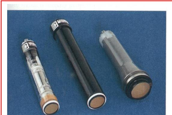
**Fig. 2.10**, estas três variações de câmara de TV *vidicom* são aproximadamente de 1 polegada de diâmetro por 6 polegadas de comprimento. O tubo da direita usa um defletor eletrostático de feixe ao invés de eletromagnético.
