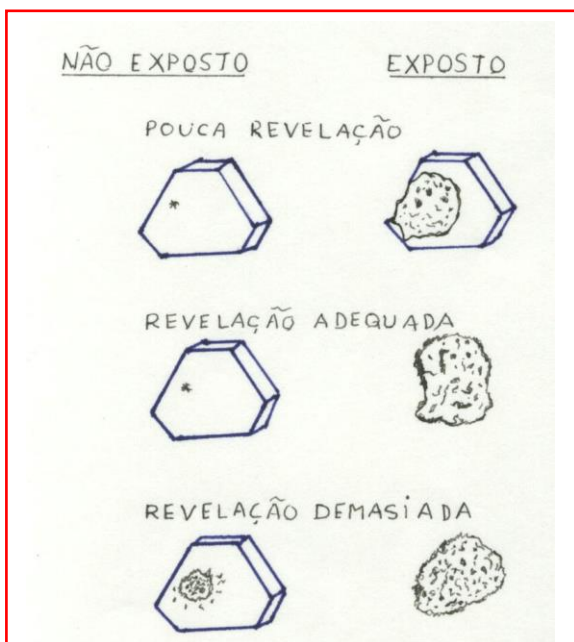
Fig. 6.10 Graus de revelação no cristal: A) pouca revelação B) Revelação ideal c) Revelação excessiva
