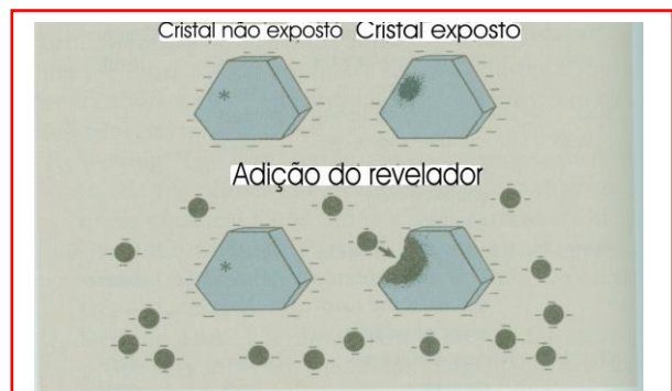
Fig. 6.9 Somente cristais que contém uma imagem latente são reduzidos a prata metálica por adição do revelador
