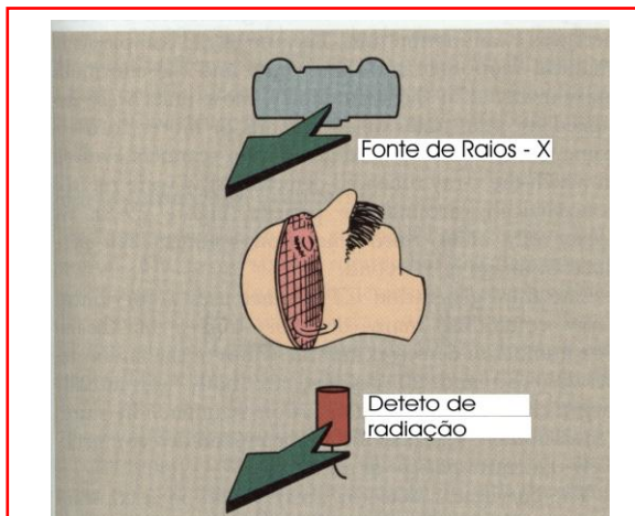
Fig. 5.3 TC simples consiste de um feixe bem colimado e um detector ambos girando sincronizadamente em um modo de rotação translacional.
